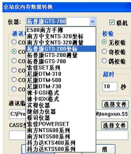
(4) 设置[全站仪内存数据转换]对话框中的[通讯口]、[波特率]、[数据位]、[停止位]等通讯参数，该通讯参数必须和电脑中的通讯参数完全相同。设置方法如下：
